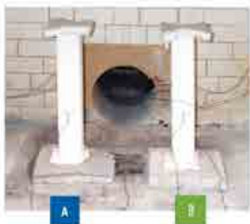
Columnas de acero antes de la prueba de fuego
