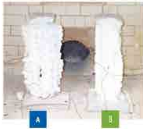
Columnas de acero después de la prueba de fuego
